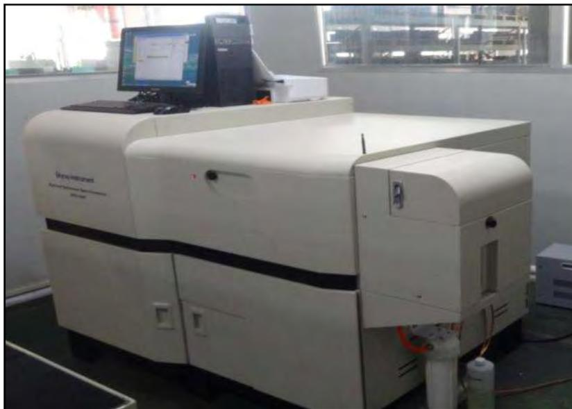
すべての金属元素を分析して原材料 (IQC) をチェックする25チャンネルの分光計を使用しています。
